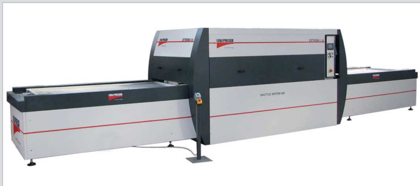
2V - Two trays configuration - opposite ends 2V - Configurazione a due vassoi di carico / scarico su lati opposti 2V - konfiguracja z dwoma stołami do załadunku/rozładunku, po przeciwnych stronach 2V- version à deux plateaux de chargement et déchargement sur deux cotés opposés 2V - Configuración con dos bandejas de carga / descarga en lados opuestos 2V - Конфигурация с двумя лотками загрузки / выгрузки с противоположных сторон
