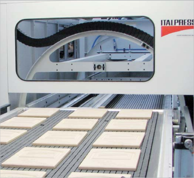
Tray turner to unload pressed panels Ribaltatore a botte per pannelli pressati Wywrotnica beczkowa do sprasowanych paneli Culbuteur a 180° Volteador de tambor de 180° para paneles prensados Барабанный опрокидыватель готовых изделий
