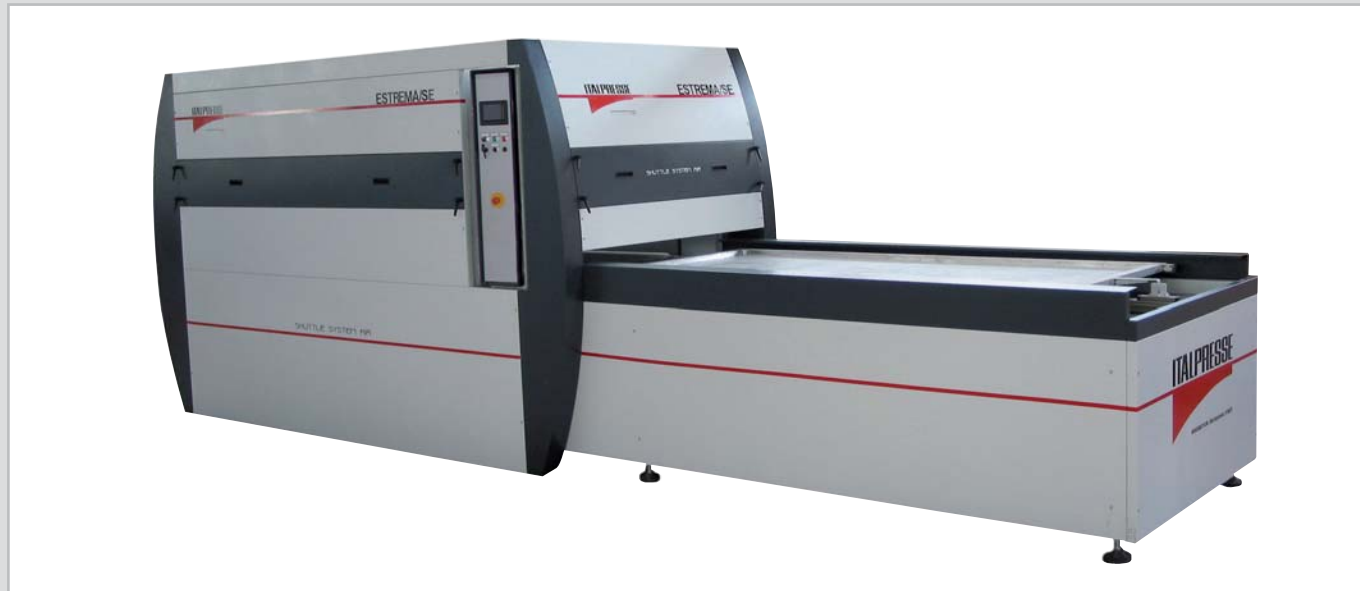
1V - Single tray configuration 1V - Configurazione ad un vassoio di carico / scarico 1V - konfiguracja z jednym stołem do załadunku/rozładunku 1V- version à un plateaux de chargement et déchargement 1V - Configuración con una bandeja de carga / descarga 1V - Конфигурация с одним лотком загрузки / выгрузки
