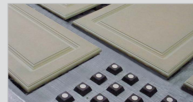
Magnetic PIN kit complete with steel sheet Kit PIN magnetici e superficie vassoio fresata e forata Zestaw PIN-ów magnetycznych i powierzchnia stołu frezowana i wiercona Jeux des inserts magnétiques et surface du tableaux usinée et percée. Kit PIN magnéticos y superficie bandeja mecanizada con fresa y taladrada Магнитные суппорты (PIN) и обработанная на фрезерном и сверлильном оборудовании поверхность лотка
